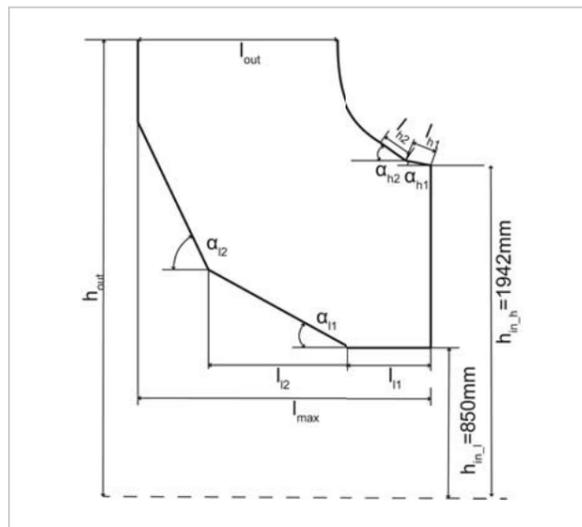
Fig. 10: Diffuser parametrization
