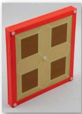
**Bild 1:** Das Antennen Array dient zur gerichteten Signalübertragung.
