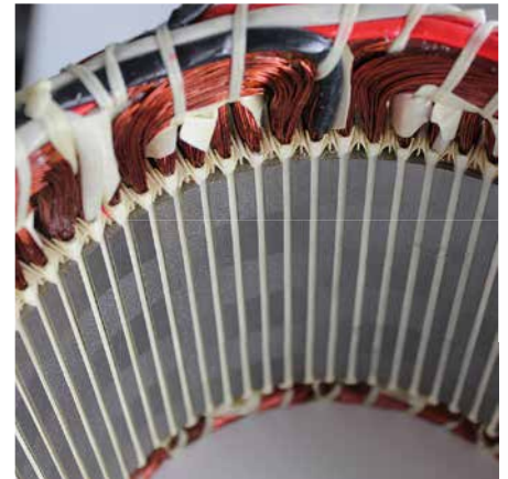
Bild 1: In den Statornuten von permanent-erregten Synchronmaschinen werden Kupferdrähte verankert.
