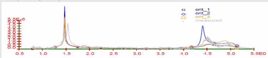
Abb. 4 Abgleich unsanierter Glockenturm
