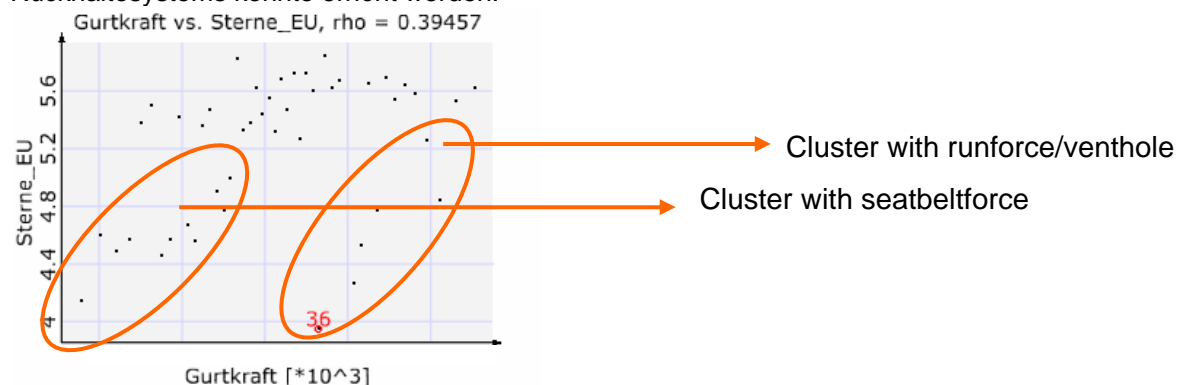
Abb. 2 Anthillplot Gurtkraft gegenüber Bewertung nach EURO NCAP. Die zwei abfallenden Cluster zeigen zwei Mechanismen des Performanceverlustes an.
