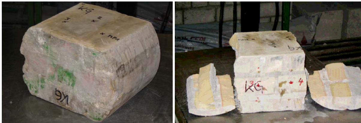
Fig. 4: Mauerwerksprobe links vor und rechts nach der Druckfestigkeitsprüfung
